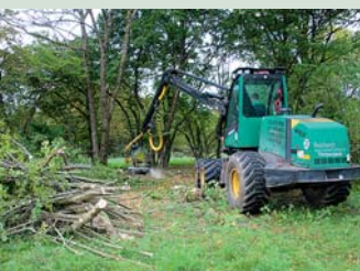
Abb. 125: Heckenpflege mit dem Bündelharvester. Bei trockenem oder gefrorenem Boden verursachen die schweren Maschinen keine Schäden am Boden und können auch abseits der Wege gut eingesetzt werden.
